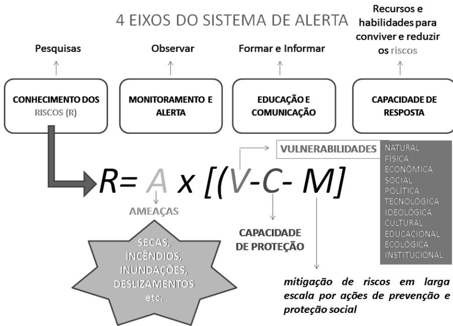
**Imagem 3:** Eixos principais de um sistema de alerta de risco de desastres. Fonte: Marchezini et al.<sup>33</sup>
