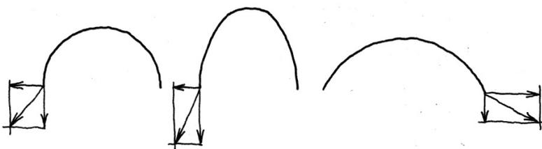
Figura 12: Diferentes relações entre espessura das paredes e altura da falsa cúpula.
